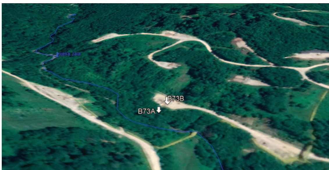
Slika 2. Položaj ušća bušotine B-73 (B-73B) u odnosu na projektirani položaj (B-73A)
