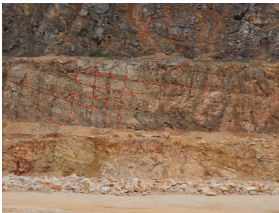
Slika 4. Uslovi bušenja i ispucalost krečnjaka na PK "Vijenac"
