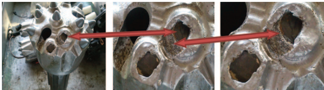
Slika 6. Izgled bušačeg dlijeta DTH čekića, sa mjestima gubitka zubi dlijeta, nakon izbušenih 384 m
