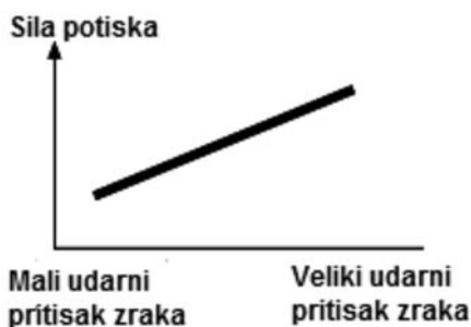
Slika 5. Zavisnost sile potiskivanja bušačeg pribora od pritiska komprimiranog zraka
