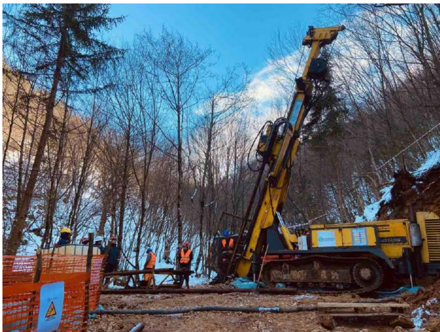
Slika 2. Bušača garintura Mustang 13 Atlas Copco (Rig Teh Istočno Sarajevo)
