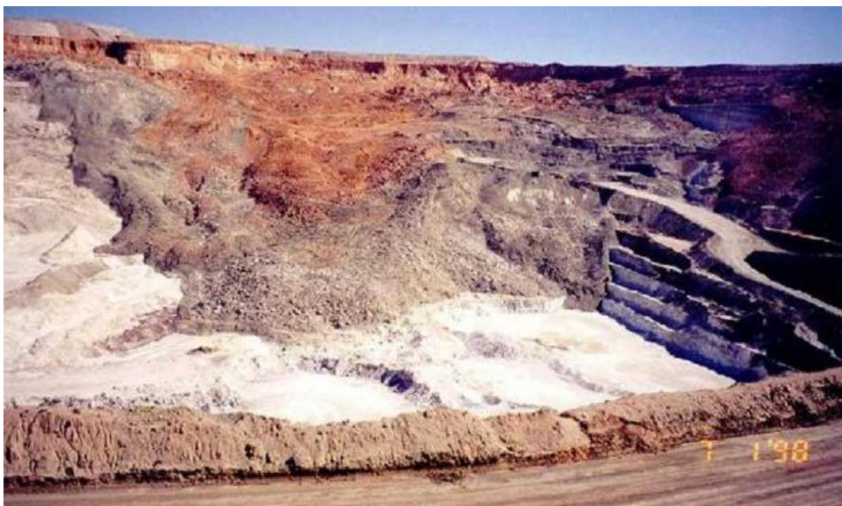
Slika 1. Klizanje etaža na površinskom kopu Rio Tinto u pustinji Mojava u regiji Kern kod Los Angelesa 1998. godine
