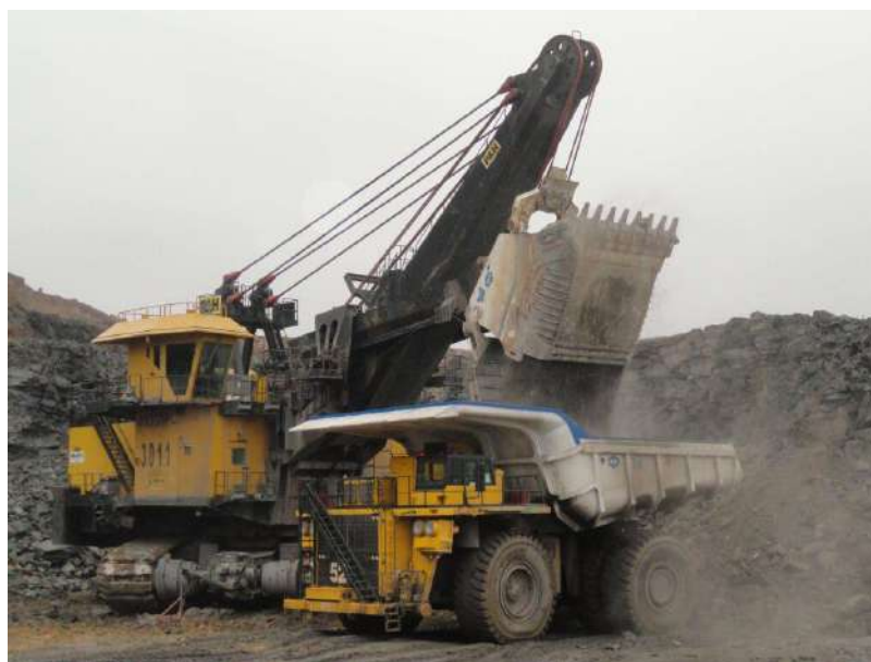
Slika 5. Utovar materijala užetnim bagerom kašikarom u kamion
